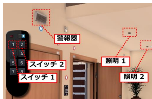
Fig. 3 実験用照明システムに使用した Home io 内機器
