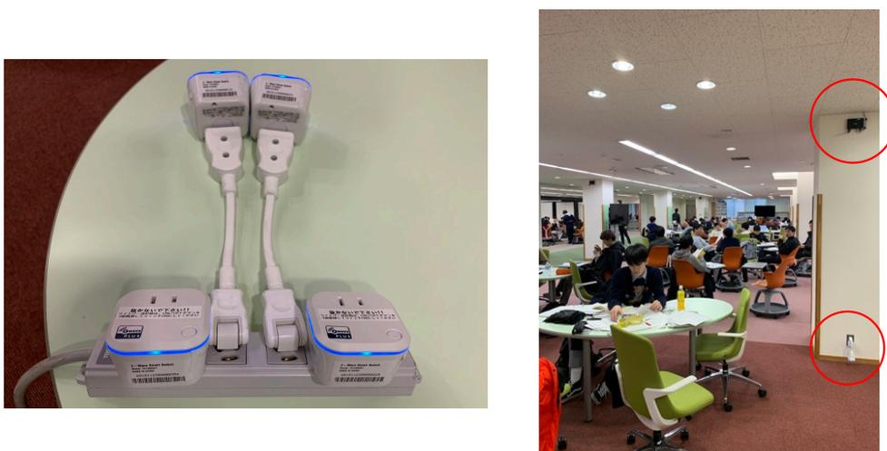
図2. 敷設した Z-wave スマートタップ (左)とゲートウェイ設置状況(右).
