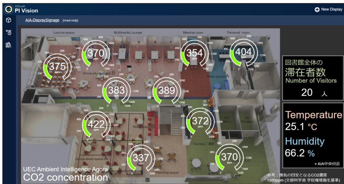
この場所は、2017年4月に本学の附属図書館と人工知能先端研究センターが設置した新学修スペース「Ambient Intelligence Agora (以下, Agora)」であり、約1,000m<sup>2</sup>の広さをもつ実験的学修スペースである。利用者が無線プレゼンテーション機器、プロジェクタ、モニタなどを使ったプレゼンテーションの練習や、ガラス製ホワイトボードを用いてディスカッションをすることが可能となっている。それらの空間に、人感・温湿度・CO<sub>2</sub>センサーやネットワークカメラなどが設置され、個人情報保護を十分に配慮したうえで、利用者の学修の様子をデータ化し、ビッグデータ、人工知能、ロボット、適応学修などの研究への活用を目指すものである。
