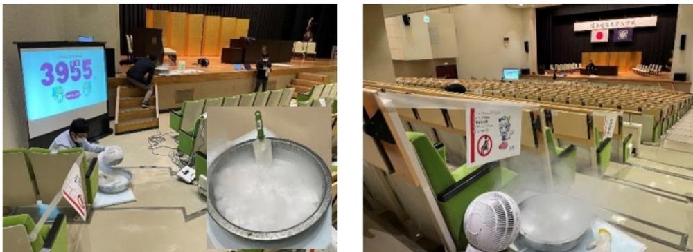
図8. ドライアイスを用いた換気量推定実験の様子.
