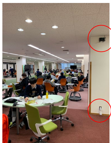
図 2.5-1, 敷設した Z-wave スマートタップ (左)とゲートウェイ設置状況(右).
