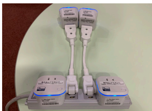
図 2.5-1, 敷設した Z-wave スマートタップ (左)とゲートウェイ設置状況(右).
